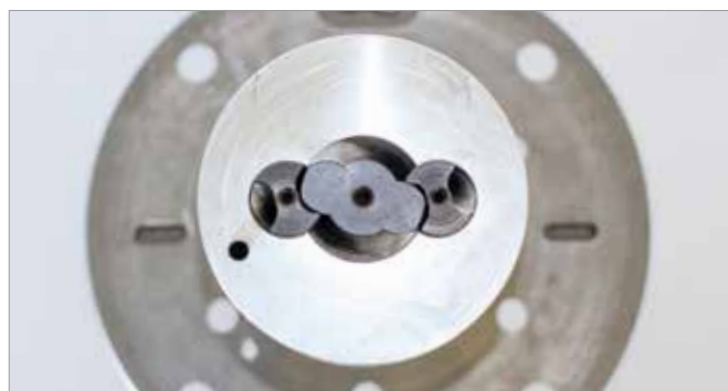
Die Schraubenspindelpumpe weist eine konstante, freie Querschnittsfläche auf. Diese gewährleistet eine kontinuierliche Verdrängung des Fördermediums.
